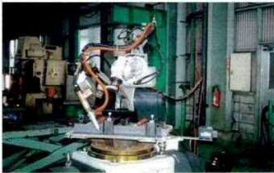
ロボット溶接に後付け吸込ノズルー建設用部材 自動溶接用トーチに後付け吸込ノズルー産業用機械部品 吸込ノズル付手持ち遮光面(半自動アーク溶接)ー産業用機械部品
